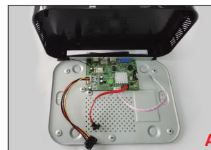
Odpojte napájanie rekordéra od siete, odskrutkujte skrutky a odoberte horný kryt.
