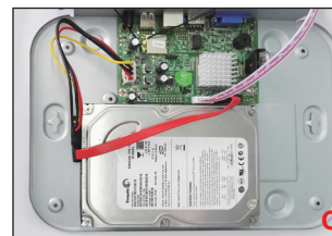
Vložte disk HDD do rekordéra. Ideálne by žiadny kábel nemal prechádzať cez disk.
