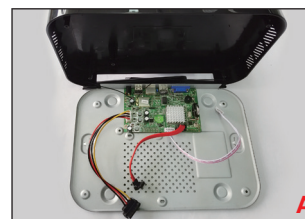
Odpojte napájení rekordéru od sítě, odšroubujte šrouby a odejměte horní kryt.
