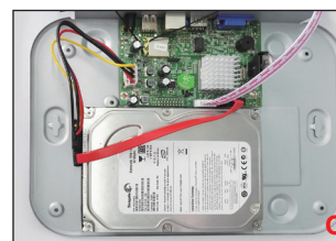
Vložte disk HDD do rekordéru. Ideálně by žádný kabel neměl procházet přes disk.
